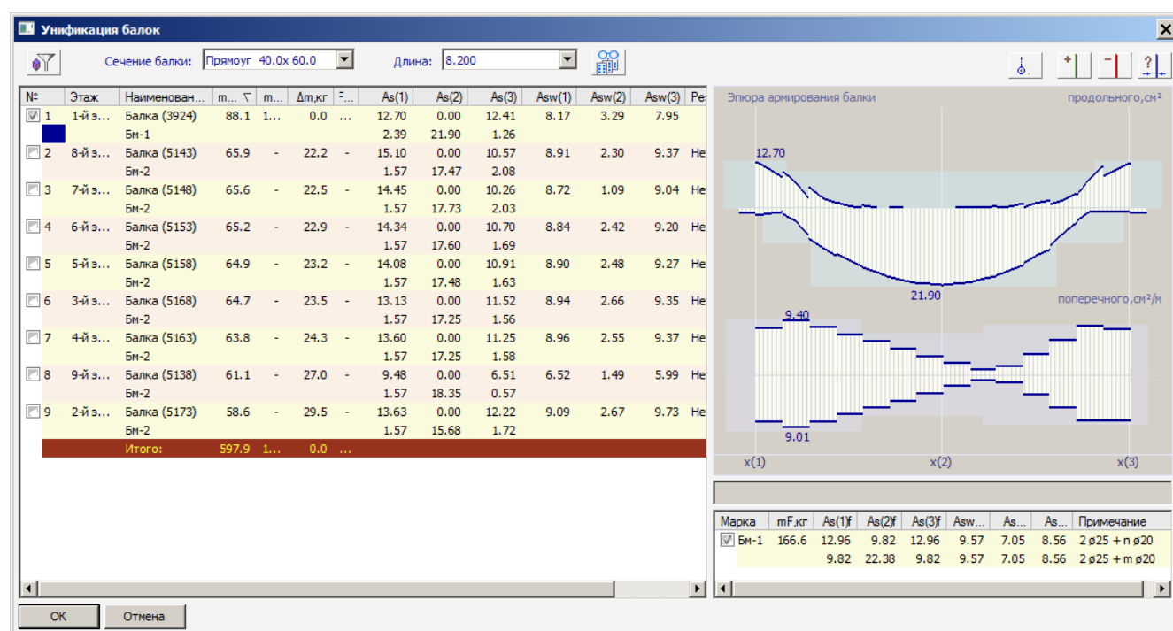
Рис.7.26. Отображение эпюр фактического и теоретического армирования для балки
